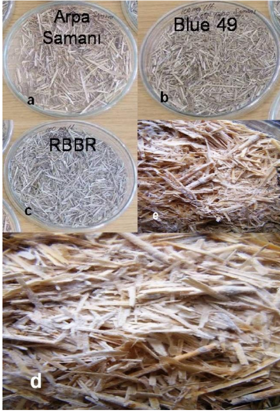
Şekil 5. KFF ortamı olarak Arpa samanının kullanıldığı çalışmalarda, inkübasyon başında ve sonundaki renk değişimleri ve P. sajor-caju gelişimi ( a -Arpa Samanı (kontrol), b -Arpa Samanı +100 mg/l Blue 49 (kontrol), c -Arpa Samanı 100 mg/l RBBR (kontrol), d -Arpa Samanı +Blue 49 100 mg/l + P. sajor-caju – KFF denemesi, e -Arpa Samanı +RBBR 100 mg/l + P. sajor-caju – KFF denemesi)
