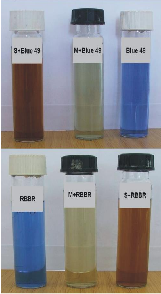
Şekil 3. Blue 49 ve RBBR çözeltilerinde (100 mg/L), arpa samanı (S) ve mısır koçanının (M) adsorbant olarak kullanıldığı deneme sonrasındaki dekolorizasyon
