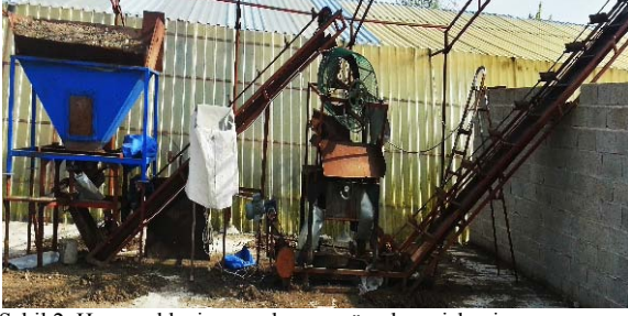
Şekil 2. Hammaddenin parçalama ve ön eleme işlemi.
