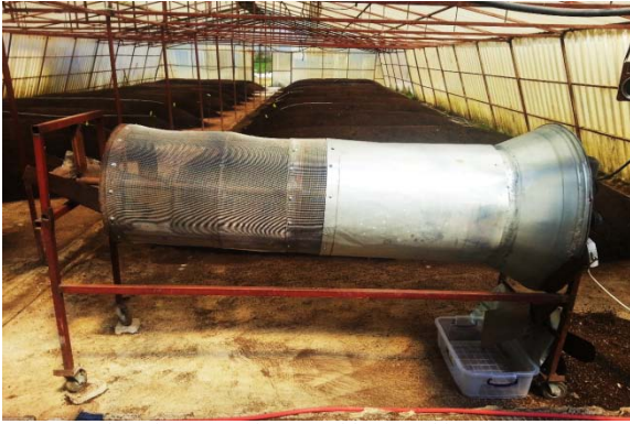
Şekil 3. Gübre eleme ve solucan ayıklama makinası
