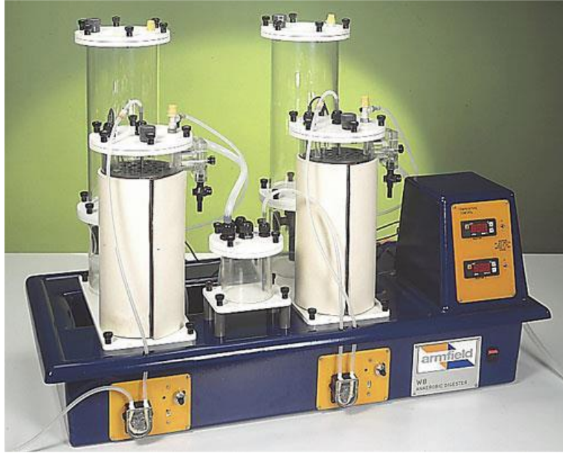
Figür. 1. Yukarı akışlı anaerobik dolgulu yatak reaktör
